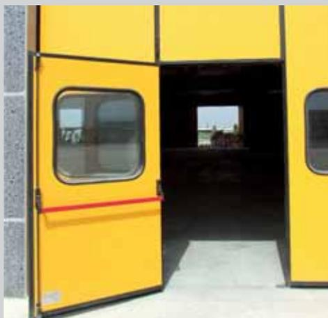
Anta tagliata, disponibile solo su modelli LN e LE, con profilo di battuta superiore in alluminio nero, dotata di maniglione antipanico con 2 punti di chiusura (alto/basso), con cilindro e maniglia esterna. L'incontro aereo rende solidale la porta con il pannello superiore laterale, una speciale staffa permette una battuta ottimale sulla battuta a terra.
