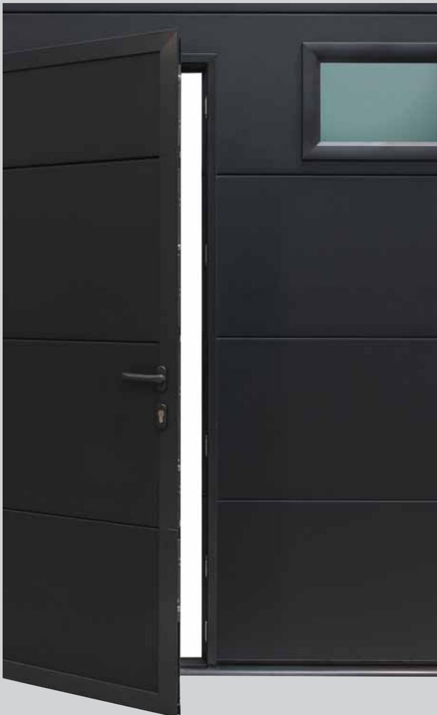
Porta pedonale inserita nel manto completa di soglia ribassata, cerniere a scomparsa inserite nei profili di alluminio disponibili in tutte le tinte RAL ed effetto legno, completa di micro di sicurezza. Esiste la possibilità di adottare serrature a 3 e 5 punti di chiusura.
